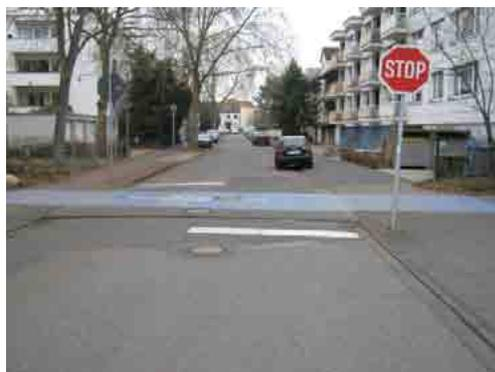
Bild 7-9 Blau eingefärbte bevorrechtigte Querungsstelle eines selbstständig geführten Radweges (Bonn)
